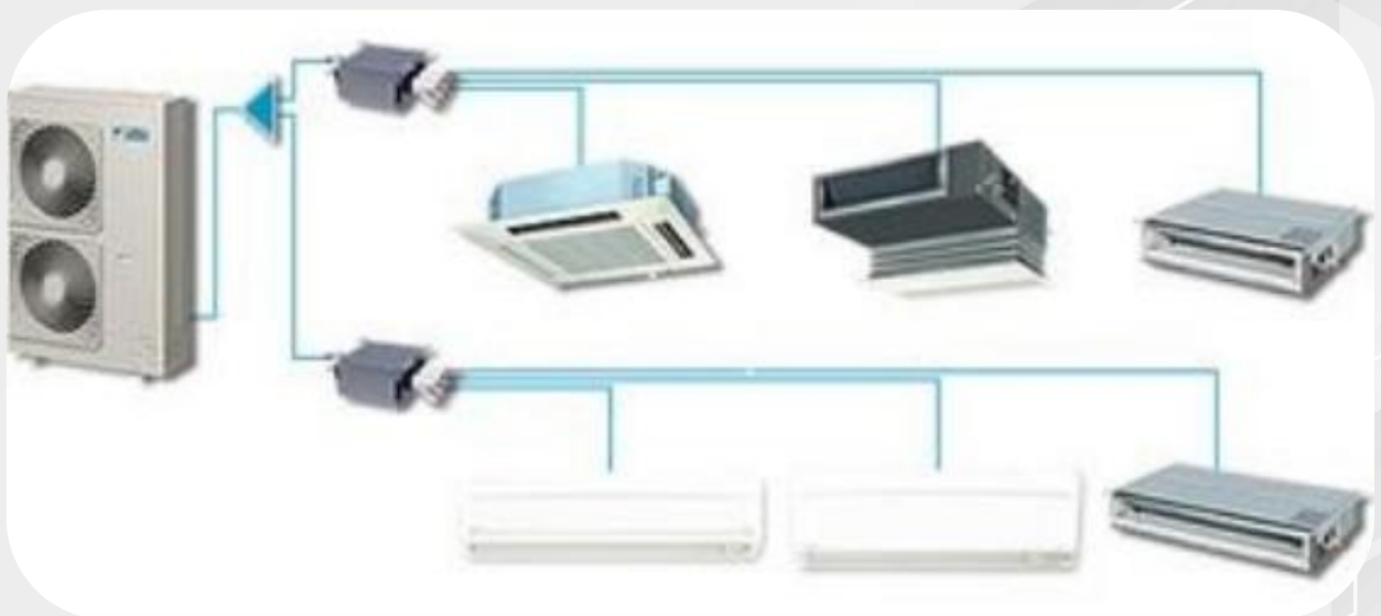
Hệ thống điều hòa không khí VRF/ Air conditioning VRF System
